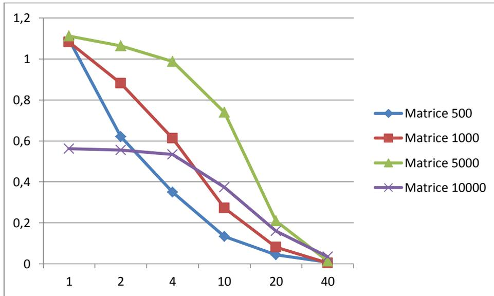
Nous constatons qu'il est impossible d'obtenir un rendement parfait en fonction du nombre d'hôte et que même si le temps de calcul chute de manière importante avec la parallélisation, on constate une baisse successive du rendement.
